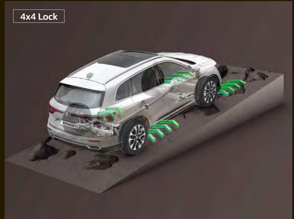
Válassza az Auto üzemmódot és a rendszer optimalizálja a nyomatékeloszlást az első és a hátsó kerekek között, a mindenkori megosztást pedig jelzi a TFT műszerfalán. Alacsony sebességnél a Lock mód segít abban, hogy a négykerék-hajtás egyenlő erőt juttat az első- és a hátsó kerekekre, így az autó különlegesen stabil marad, és minden akadályt leküzd.
